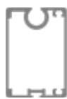
Lourd 28,6 x 41,9 mm Lestage double pour verticoffres étroites avec grande hauteur et stabilité supplémentaire avec des verticoffres large.
