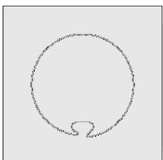
6253 247-000 Tube d'enroulement 63 x 0,9 mm avec gorge plate Galvanisé 7,5
