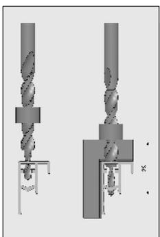
4452 491-068 Mèche à gradin 4-7 mm avec anneau pour le profil de finition
