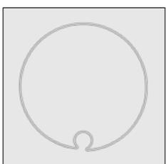
6253 382-000 Tube d'enroulement 85 x 1,25 mm avec gorge ronde Galvanisé 4,0
