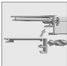
4452 490-000 Mèche à gradin 4-7 mm pour le profil de finition
